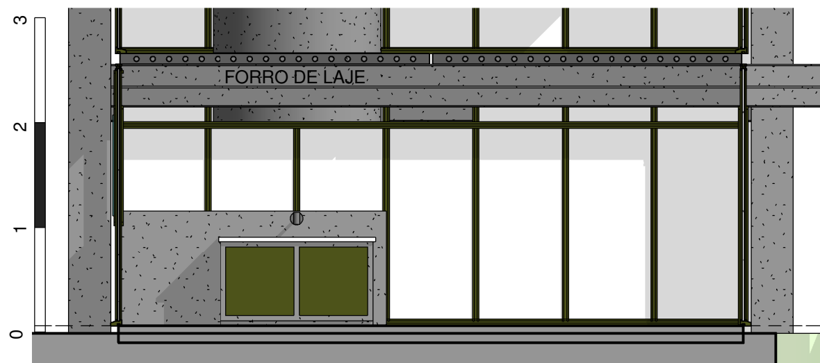
PASSAGEM DE FIOS DENTRO DE PERFIS DOBRADOS 2,5X1CM - DETALHADO NO PROJETO ORIGINAL
